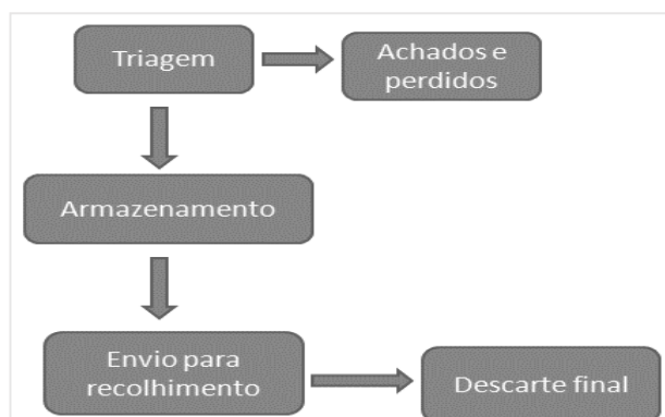
Figura 01: Fluxograma de manejo dos resíduos gerados “in loco”.
